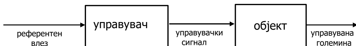
Слика 6-1 Отворен систем на автоматско управување
