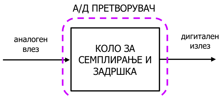
Слика 6-16 Упростена структурна блок-шема на еден А/Д претворувач
