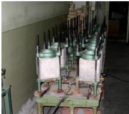
Слика 2.9 Испитување водонепропустливост на бетон
