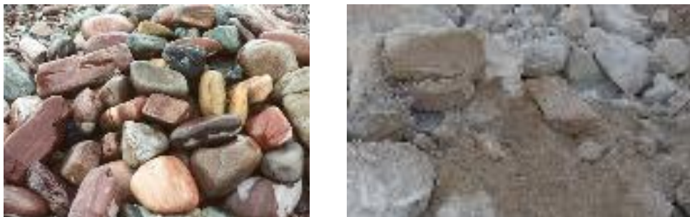
Слика 6.16 Изглед на агрегат за бетон
