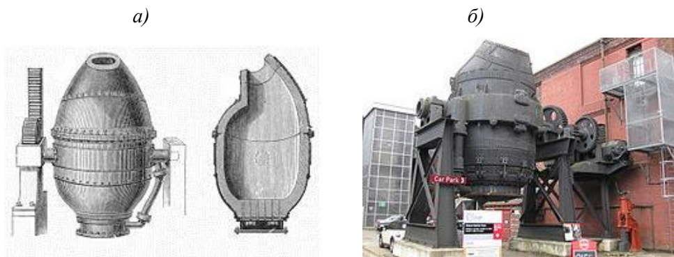
Слика 7.4 Бесемеров конвертор за добивање на челик: а) шема, б) Бесемеров конвертор во Шефилд, Велика Британија
