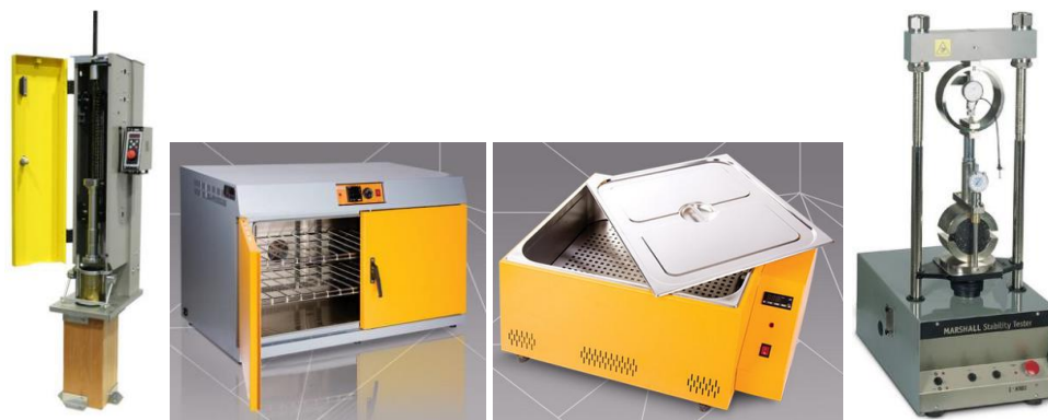
Слика 10.8 Испитување со Маршалова метода: набивач, сушилница, водена бања, Маршалова преса
