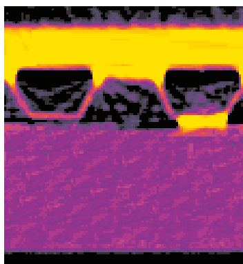
Слика 3.10 Томографска снимка на пресек низ врска метал-керамика
