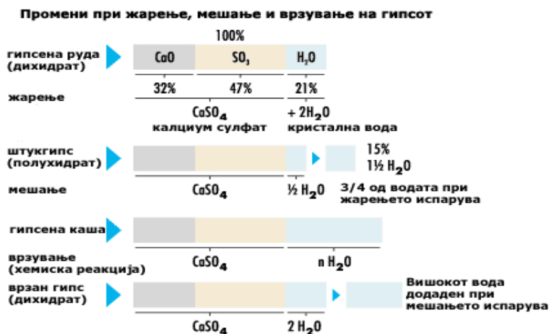
Слика 5.2. Хемиски состав и добивање на градежен гипс
