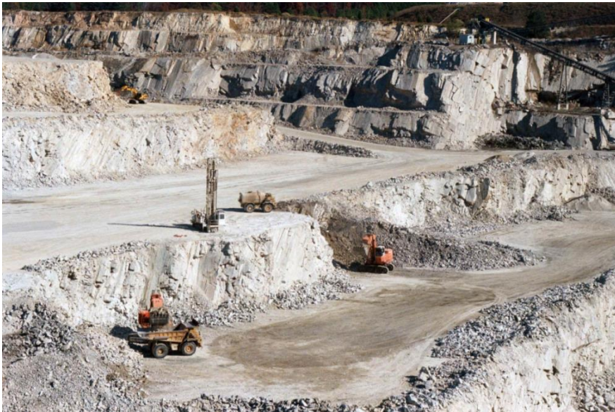
Слика 4.3 Добивање на камен во каменолом
