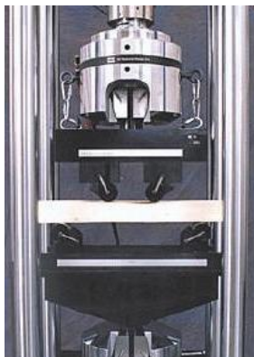
Слика 6.4 Преса за испитување јакост на свиткување и шема на товарење
