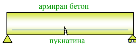
Слика 6.12 Пукнатини кај армиранобетонски греден носач
