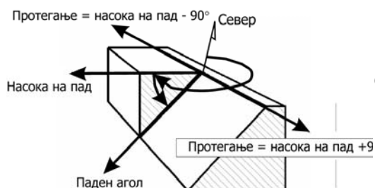
Слика 1 Илустрација на протегање, насока на пад и паден агол на една рамнина
