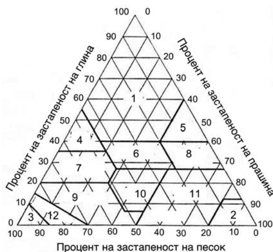
Слика 9.15 Триаголен дијаграм за проценка на тип на почва и проценка на коефициент на еродибилност K (види Табела 9.3) 1 - глина; 2 - прашина; 3 - песок; 4 - песоклива глина; 5 - прашињеста глина; 6 - прашињесто песоклива глина; 7 - песокливо прашињеста глина; 8 - глиновита прашина; 9 - глиновито-прашињест песок; 10 - прашињесто глиновит песок; 11 - глиновито песоклива прашина; 12 - слабо заглинет песок.
