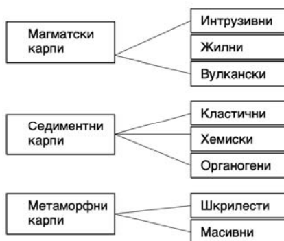
Слика 4.1 Општа поделба на карпите со приказ на основните подгрупи според настанокот или склопот
