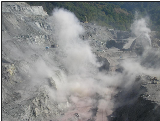
Слика 15.49 Масовно минирање на површинскиот коп за железо и никел „Ржаново“ - Кавадаречко
