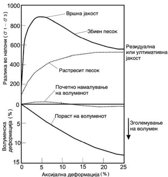
Слика 12.37 Приказ на начин на деформирање кај несврзани почви, во зависност од степенот на збиеност во услови на триаксијална компресија
