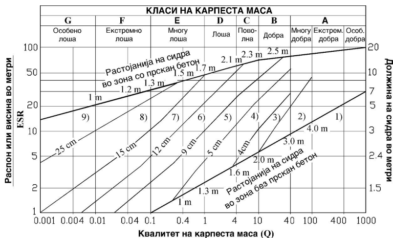
Слика 15.35 Синтезен дијаграм за проценка на тип на подградба во зависност од квалитетот на карпеста маса според Q-системот
