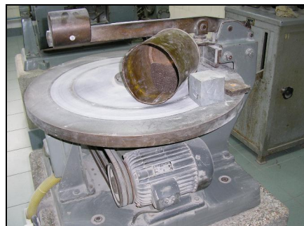
Слика 7.43 Приказ на апаратура за испитување на абење на карпите со машина тип Беме, (а) и детаљ од ставање на абразивно средство во жлебот на плочата (б) (фото Р. Петровски)
