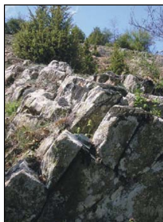
Слика 12.19 Амфиболити од брана Будинарци, Берово со три изразени ортогонални пукнатински системи (GSI=50-55)
