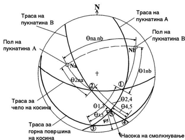
Слика 9.93 Приказ на потребни агли и параметри на стереографска проекција за пресметка на стабилност на клин омеѓен со две пукнатини
