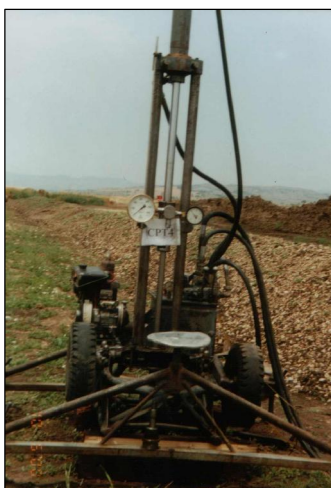
Слика 14.38 Статички пенетрометар од хидрауличен тип
