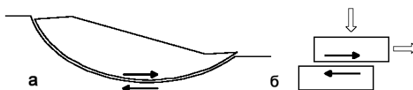
Слика 9.77 а - Приказ на идеализиран случај на смолкнување на косина главно со ротација на масите по должина на површината на лизгање, б - аналогија на процесот со опит на директно смолкнување
