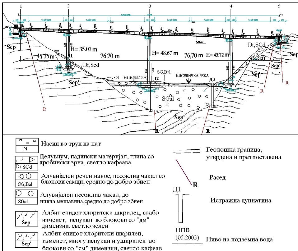
Слика 15.63 Инженерскогеолошки профил за мост преку Киселичка Река од автопатското решение за Коридор К-8 од Крива Паланка кон Деве Баир, како основа за избор на тип на фундаирање на мостот
