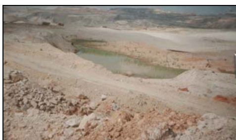
Слика 9.71 Зона на депресија кај свлечиште во СИ дел на П. К. „Суводол“ со појава на заезерена вода во вид на изданско око
