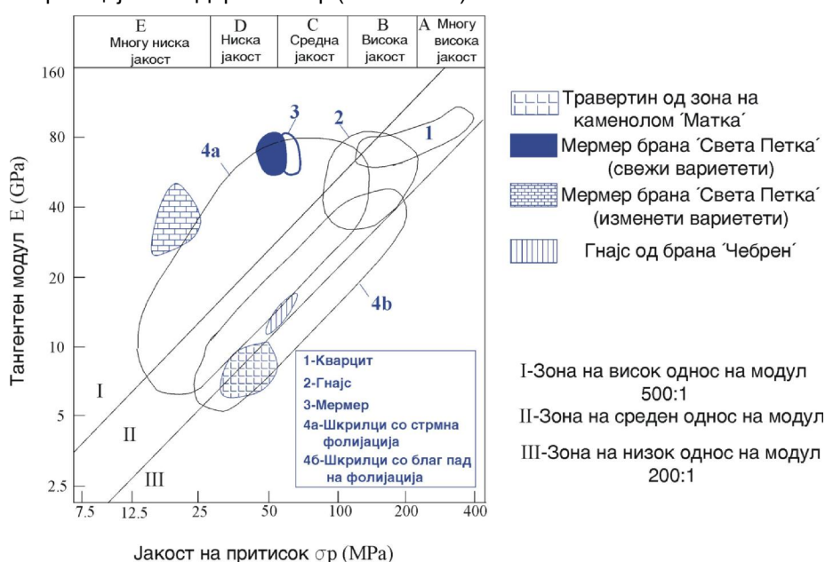
Слика 7.34 Дијаграм со приказ на односи меѓу тангентен модул на еластичност и јакост на притисок
