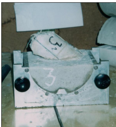
Слика 7.31 Подготовка на примерок за испитување на јакост на смолкнување по должина пукнатини
