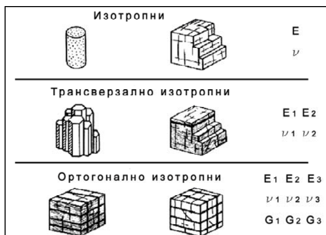
Слика 12.21 Различни типови карпи според структура и напонско-деформациско однесување (В. Витке, 1990)
