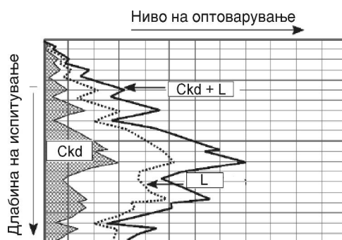
Слика 14.40 Дијаграми на регистрација на различни отпори при продирање на цевките и конусот при опит на статичка пенетрација
