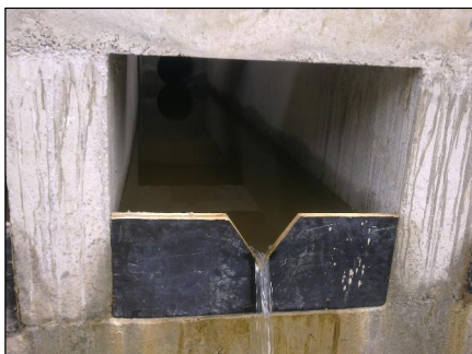
Слика 8.27 Пример за триаголен дрвен преливник за мерење на дренажни води кај браната Кнежево - Злетовско
