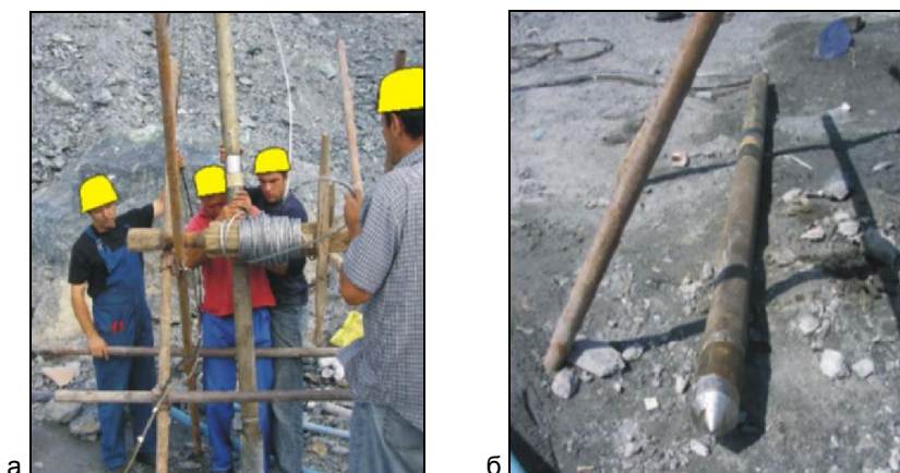
Слика 14.49 а - Сондажен диалтометар со дијаметар 96 mm на локација на испитување во рудник Ржаново, б - детал на диалтометарот
