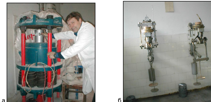
Слика 7.39 а - Апарати за едометарски испитувања на крупнозрни почви, б - Апарат за испитување на деформабилност на ситнозрни почви
