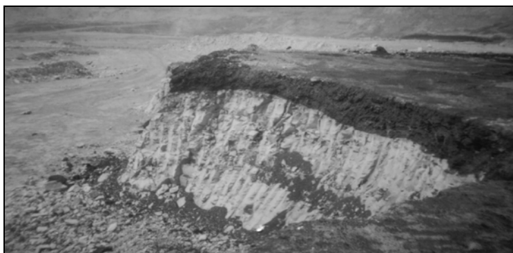
Слика 9.79 Секундарно навлекување на јагленов слој над слој од трепел од П. К. Суводол (јагленот во регуларна состојба пред свлекување бил под слојот од трепел)
