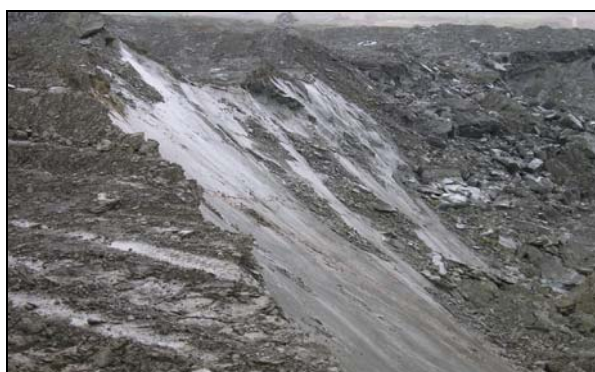
Слика 9.67 Површина на свлекување со траги на лизгање (стрии) по должина на косина од површинскиот коп за јаглен П. К. "Суводол"-Битола
