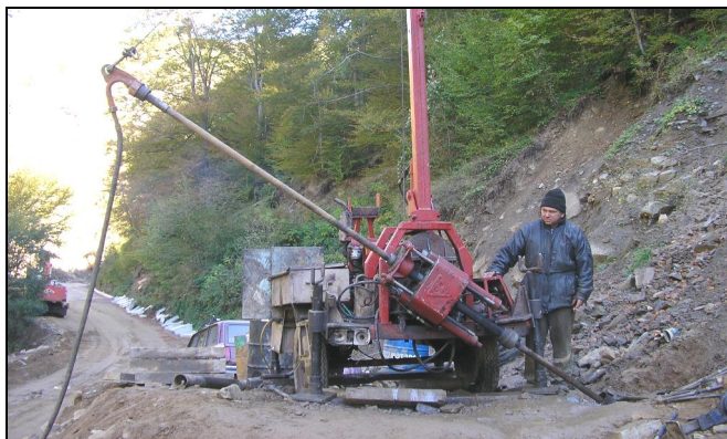
Слика 14.27 Подвижна машина за ротациско дупчење применета за изведба на коса дупнатина при истражување на свлечиште на пат за брана „Кнежево“ ХС „Злетовица“
