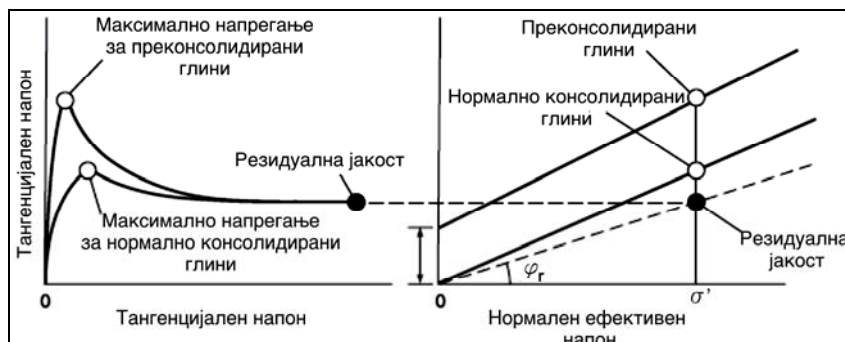
Слика 12.32 Пад од максимална до резидуална јакост дефинирана само со резидуален агол на внатрешно триење ( \phi_r ) за нормално консолидирани и преконсолидирани глини
