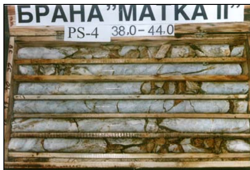
Слика 6.33 Пример за карпеста маса со RQD = 60%, јадро од истражна дупнатина за брана Света Петка (Матка II) фото З. Илијовски
