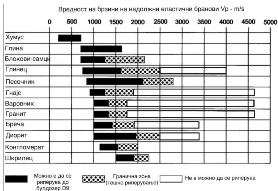
Слика 12.11 Дијаграм за проценка на можноста за риперување врз основа вредности на брзини на надолжни еластични бранови
