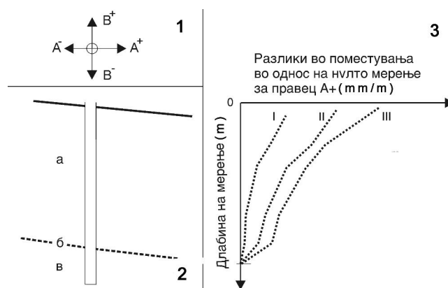
Слика 14.66 Презентација на начин на интерпретирање на податоци од инклинометарски мерења: 1 - шема за означување на 4 главни насоки за мерење; 2 - шематски приказ на вграден инклинометар во нестабилна зона (а) со зона на лизгање (б) и стабилна подлога (в) ; 3 - дијаграм на разлики во читања за три серии на мерења (I до III).
