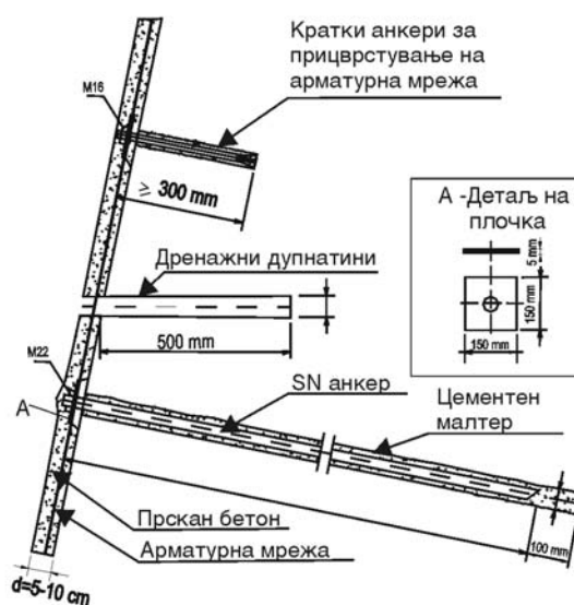
Слика 16.10 Основни елементи на еден атхезионен SN-анкер
