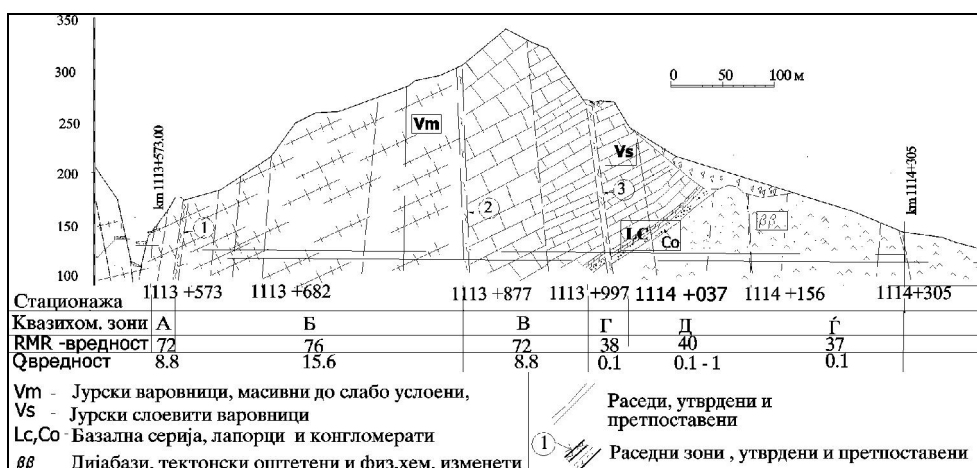
Слика 15.31 Пример за издвоени квазихомогени зони (А до Г) за тунел 2 од автопат Е75 од Демир Капија до Гевгелија
