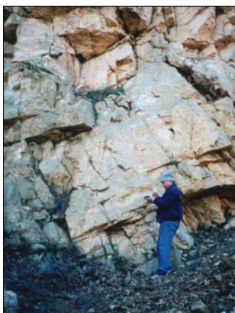
Слика 6.20 Испукана мермерна карпеста маса со блоковска структура формирана од три приближно ортогонални пукнатински системи (мермери на засек од патот за с. Здуње, фото В. Ангелов)
