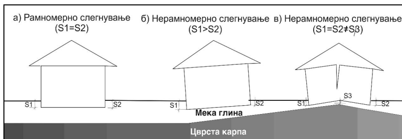
Слика 10.3 Приказ на рамномерни и нерамномерни слегнувања и шематски изглед на деформации кај објектите
