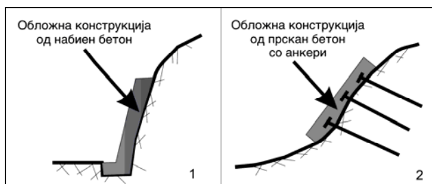
Слика 9.105 Санација на косини со обложни потпорни конструкции: 1 - од бетон, 2 - прскан бетон и анкери
