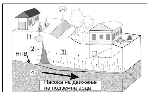
Слика 8.50 Приказ на загадување на подземни води од оштетен резервоар за бензин (1) со зона на истекување (2) и формирање на концентрација на гасови на подземната вода (4) и испарувања од гасовите во надизданската зона (3)
