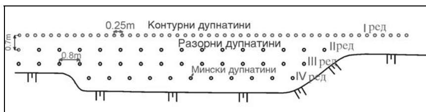
Слика 16.20 Шема на контурно минирање примената за ископот на браната „Света Петка“ - Скопско
