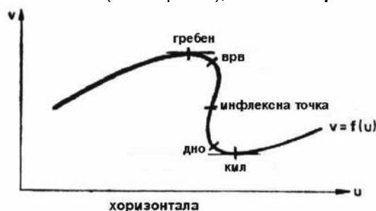
Слика 5.4 Важни структурни и хипсометриски точки на наборот во напречен профил
