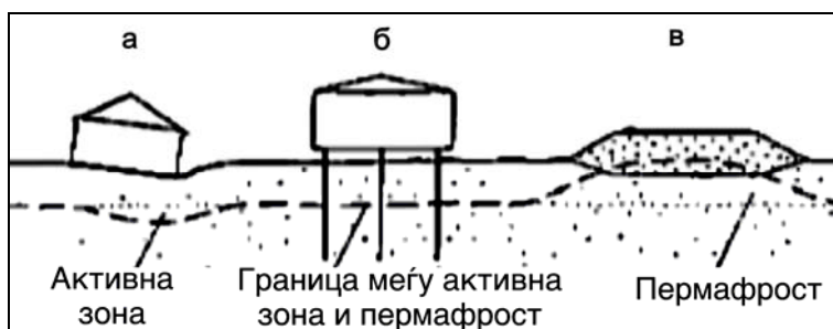
Слика 12.38 а - Објекти кои се деформирани при одмрзнување поради плитко фундамирање во активна зона, б - објект фундиран на колови во пермафрост и в - насип во активна зона но со замрзната подлога
