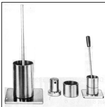
Слика 7.46 Апаратура за дефинирање на вредноста на влијание на удар врз агрегатот (AIV-вредност).
