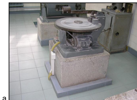
Слика 7.43 Приказ на апаратура за испитување на абење на карпите со машина тип Беме, (а) и детаљ од ставање на абразивно средство во жлебот на плочата (б) (фото Р. Петровски)
