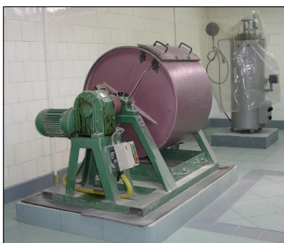
Слика 7.41 Приказ на апаратура за испитување на абеење на карпите со метод Лос Анцелес (фото Р. Петровски)
