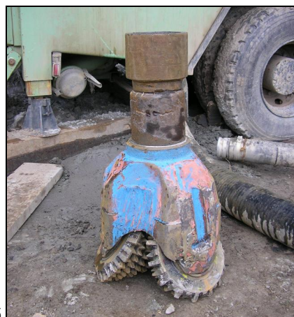
Слика 14.31 а - Машина за реверсно дупчење на бунари; б - еден тип на длето за дупчење
