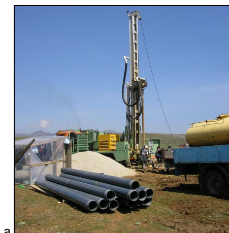
Слика 14.31 а - Машина за реверсно дупчење на бунари; б - еден тип на длето за дупчење
