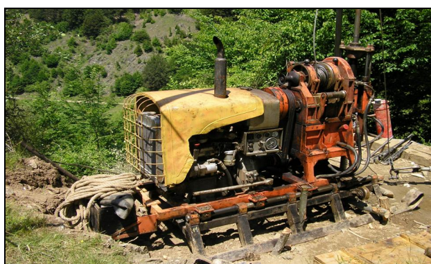
Слика 14.30 Машина за дупчење поставена на санки
