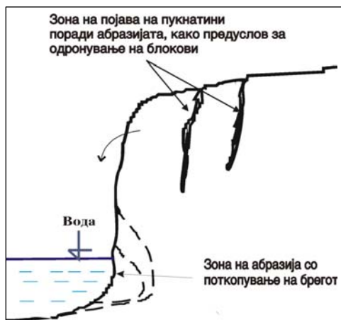
Слика 9.45 Шематски приказ на процес на абразија со поткопување во зона на контактот карпа-вода, кој дополнително може да предизвика забрзано одронување на брегот.
