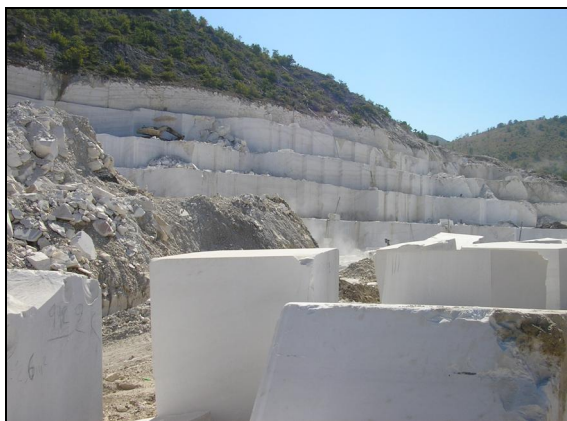
Слика 13.24 Изглед на ископ кај наоѓалиште „Беловодица“ - Прилепско и издвоени блокови со метарски димензии во преден дел на фотографијата (фото Д. Галески)
