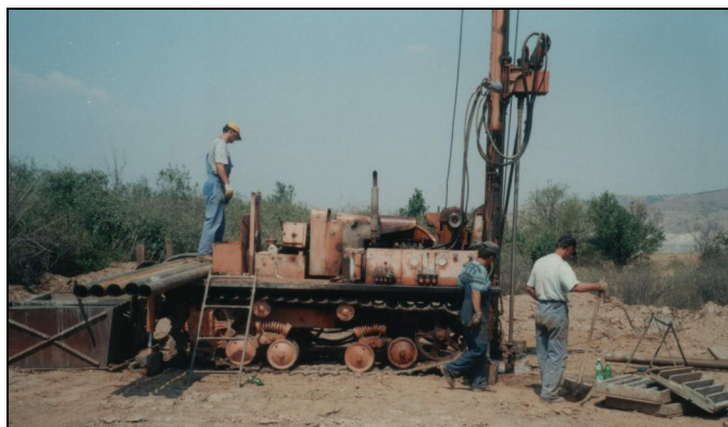
Слика 14.28 Подвижна машина за ротациско дупчење поставена на гасеници применета за истражување на јаглен при П.К. „Суводол“
