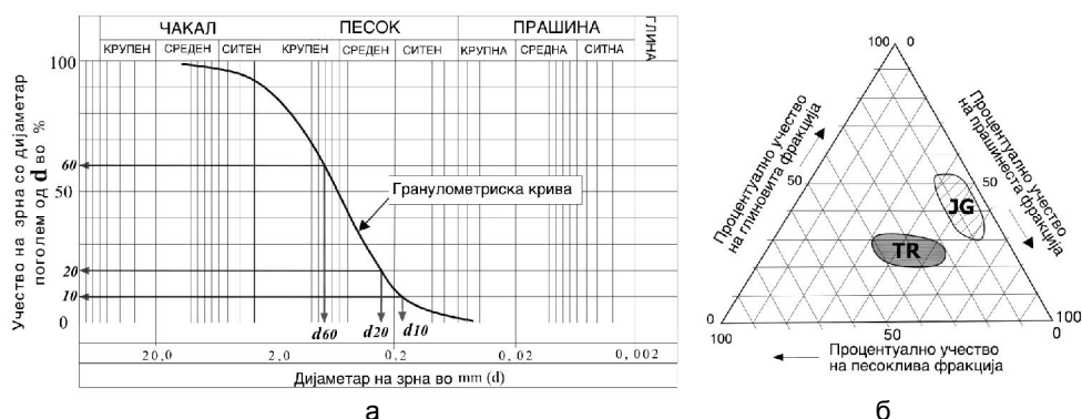
Слика 7.2 а - Полулогаритамски дијаграм на гранулометриски состав со пример за определување на типични дијаметри на зрната, б - триаголен дијаграм со приказ на зафатени зони за седиментни членови трепел и јагленова глина од П. К. Суводол - Битола
