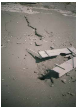
Слика 9.56 Исфрлен материјал од дупнатина во СИ дел од П.К.Суводол –Битола по пробивање на артеиска водоносна зона
