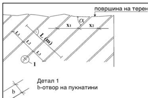
Слика 6.28 Приказ на еден систем на пукнатини со одреден паден агол ( \alpha ) дефинирани со ширината на отворот (b)
