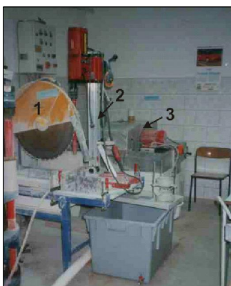
Слика 7.16 Опрема за подготовка на пробни тела за испитување 1 - Машина за сечење на примероци со дијамантска пила; 2 - Машина за дупчење примероците; 3 - Машина за полирање.
