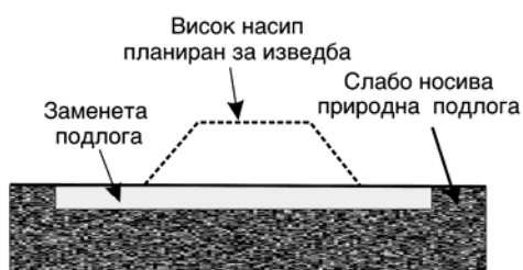
Слика 9.103 Превентивно подобрување на слабоносива подлога на која треба да се гради висок насип, со цел да се спречи негово идно свлекување
