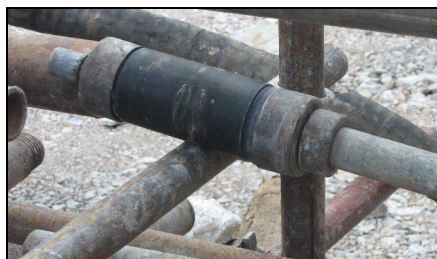
Слика 14.79 Изглед на гумен дел наречен пакер, поставен на дупчечките шипки за изолирање на делницата за испитување
