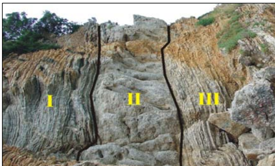
Слика 6.9 Реален изглед на хетероген варовнички масив: I, II, III - квазихомогени зони според состојбата на испуканост на варовникот (фото Бл. Маркоски)
