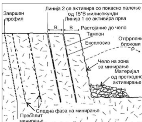
Слика 16.21 Приказ на пресплит техника на минирање кај отворени етажи
