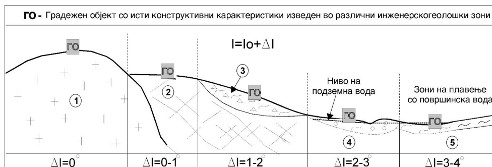
Слика 11.18 Шематски профил на терен во исто епицентрално подрачје со илустрација на влијание на степенот на компактоста на карпата врз прирастот на интензитетот на земјотрес ( \Delta I ), споредено со основниот степен на сеизмичност ( I_0 )
