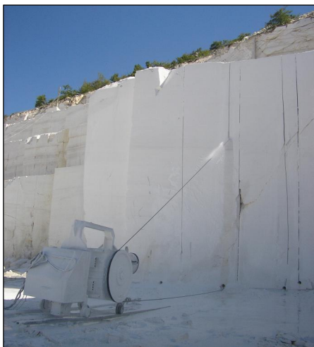
Слика 13.23 Експлоатација на мермерни блокови од бел сахароиден мермер од наоѓалиште „Беловодица“ - Прилепско со сечење преку сајли (фото Д. Галески)
