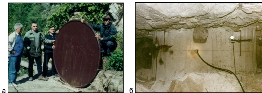
Слика 14.46 а - Изглед на перница пред вградување во истражна галерија; б – поглед кон забетонирана хидрауличка перница во прорез во карпестата маса (локација брана „Света Петка - Скопско“)
