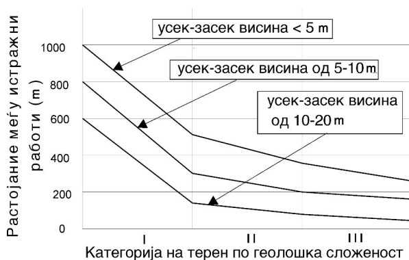
Слика 14.82 Дијаграм за проценка на потребни растојанија меѓу истражни работи кај усеци и засеци
