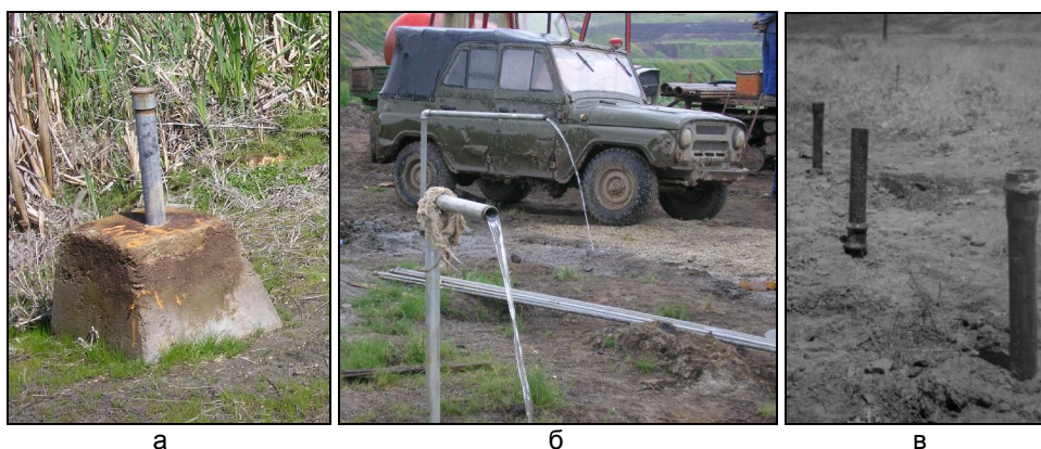
Слика 14.70. Изглед на пиезометри вградени во ПК. „Суводол“ - Битолско: а - единечен пиезометар; б - двоен пиезометар со појава на артески води од две различни зони под притисок; в - троен пиезометар
