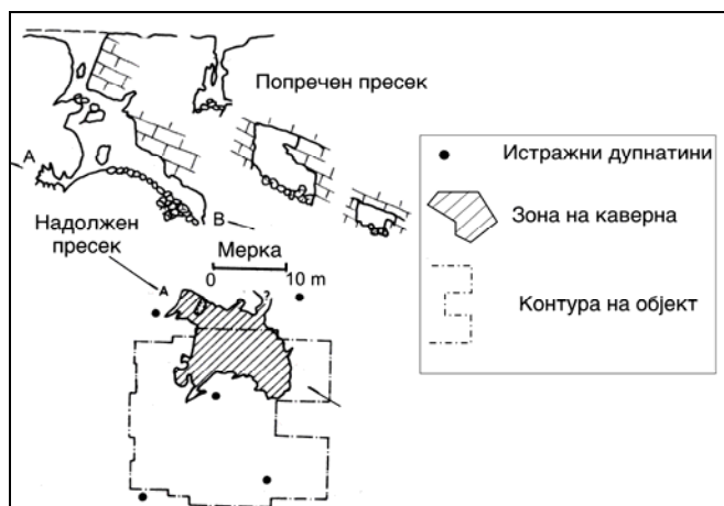
Слика 12.28 Попречен пресек и ситуација на каверни при изведба на станбен комплекс во карбонатен терен во Р Хрватска (Божичевиќ, 1983)
