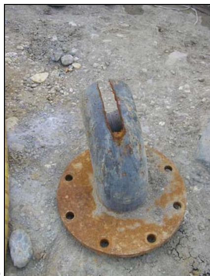
Слика 9.55 Појава на интензивна суфозија во близина на с. Меџитлија, Битолско низ стара дупнатина: а - избивање на вода, гасови и материјал од дупнатината, б - целосно абрадирано челично колено кое било поставено на устие на дупнатината при исфрлање на вода и песок под притисок (фото М. Ефтимов)
