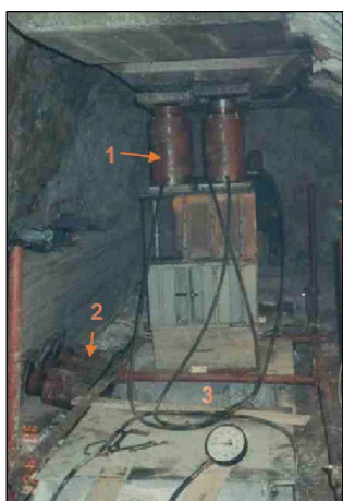
Слика 14.55 Теренски опит на смолкнување во голема мерка систем бетон-карпа применет во една истражна галерија од лачната брана „Света Петка“:
