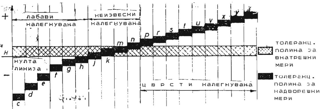
Сл.5.1 Положби на толеранциските полина во системот заеднички отвор
