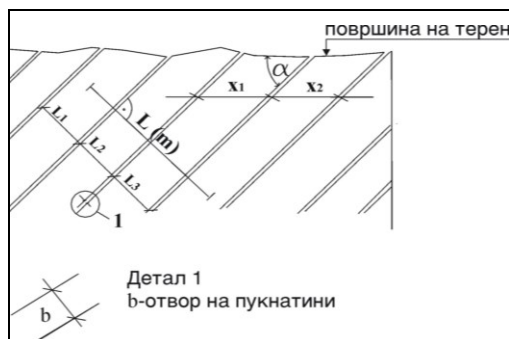
Слика 5.11 Приказ на еден систем на пукнатини со одреден паден агол ( \alpha ) дефинирани со ширината на отворот ( b )
