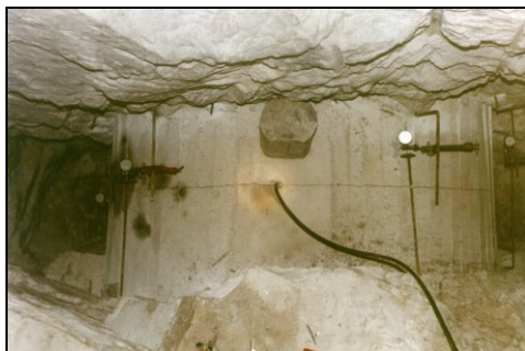
Слика 12.20 Изглед на вградена хидраулична перница во прорез во карпестата маса, забетонирана и со поставени инструменти за мерење на ободните деформации (локација – браната „Света Петка“, Скопско, фотографија од М. Јовановски)
