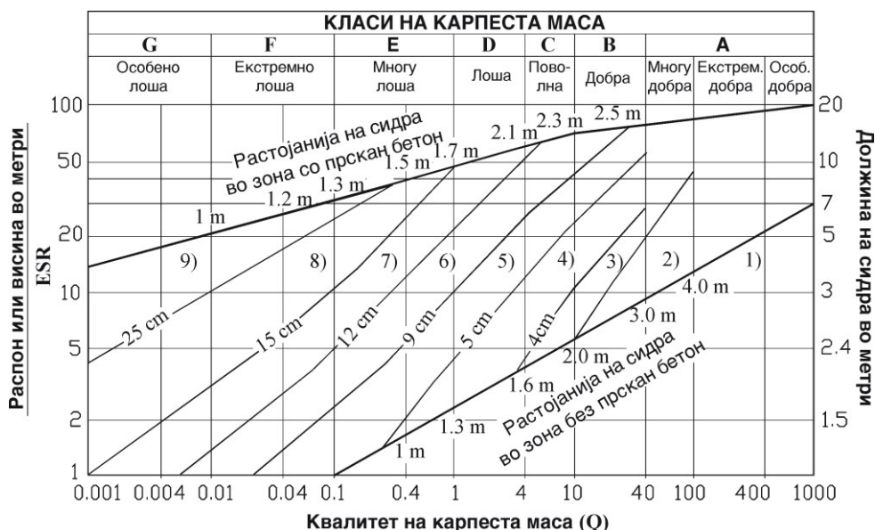
Слика 22.7 Синтезен дијаграм за проценка на тип на подградба во зависност од квалитетот на карпеста маса според Q-системот: 1 до 9 различни делови од дијаграмот со насоки за дебелина на прскач фибер бетон, растојанија меѓу сидра и други елементи: 1 - нема потреба од подградба; 2 - несистематско сидрење; 3 - систематско сидрење; 4 - систематско сидрење и неармиран прскач бетон дебелина 4-10 cm; 5 - Прскач бетон со фиброзни влакна до дебелина 5-9 cm и сидрење; 6 - Прскач бетон со фиброзни влакна до дебелина 9-12 cm и сидрење; 7 - Прскач бетон со фиброзни влакна до дебелина 12-15 cm и сидрење; 8 - Прскач бетон со фиброзни влакна до дебелина >15 cm, сидрење и ременати; 9 - Армиран бетон (од кај Бартон, 2018)
