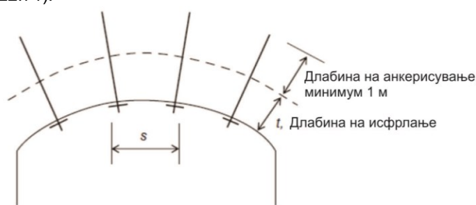
Слика 22.71 Систематско сидрење во карпи склопи кон горски удар
