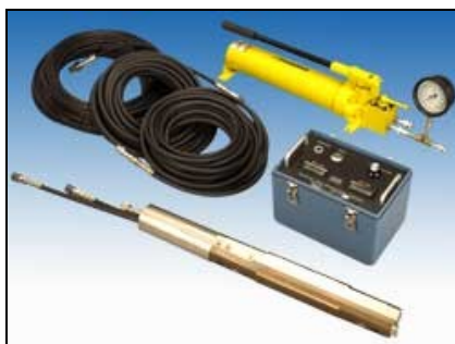
Слика 12.24 Гудманов дилатометар (анг. Goodman Jack Test), пречник 76 мм со составни елементи, како: кабли, пумпа и единица за дигитално собирање на мерени податоци
