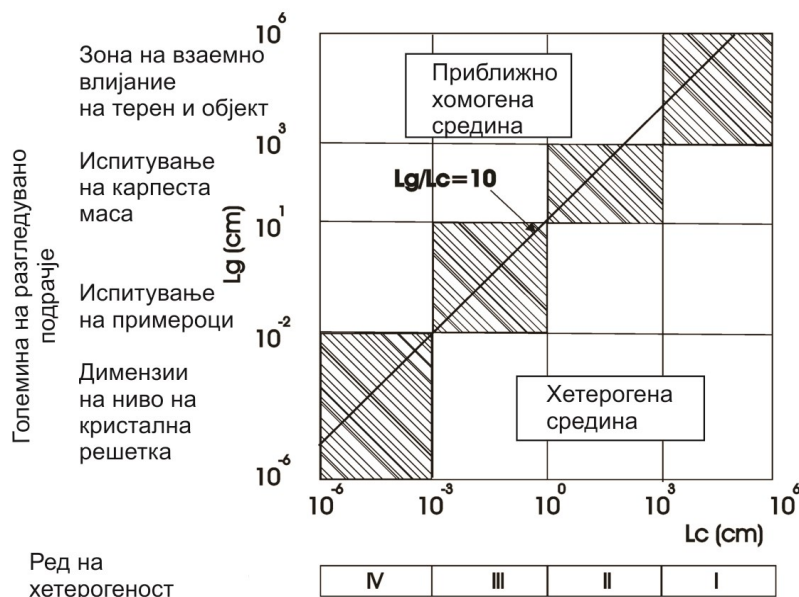
Слика 6.3. Шематски приказ на различни категории на хетерогеноста според М.В.Рац: Lc-линиска големина на елементот на хетерогеност; Lg-линиска големина на испитуваното подрачје
