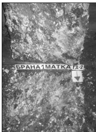
Слика 13.8 Изглед на превртен блок за увид во состојбата по смолкнување на контактот бетон – карпа на еден блок кај браната „Света Петка“ (Матка 2)
