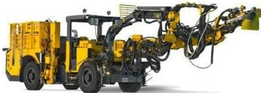
Слика 18.39 Гарнитура за вградување на сидра од типот Boltec MD од производителот Atlas Copco со директен систем за управување и висока продуктивност и прецизност. За подземни објекти и инсталација на сидра со должини од 1.5 – 3.5 m. Висински досег – 9.5 m
