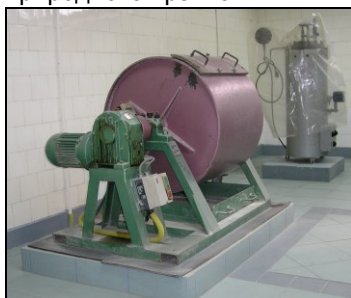
Слика 4.25 Приказ на апаратура за испитување на абење на карпите со метод Лос Анџелес (фотографија од Р. Петровски)
