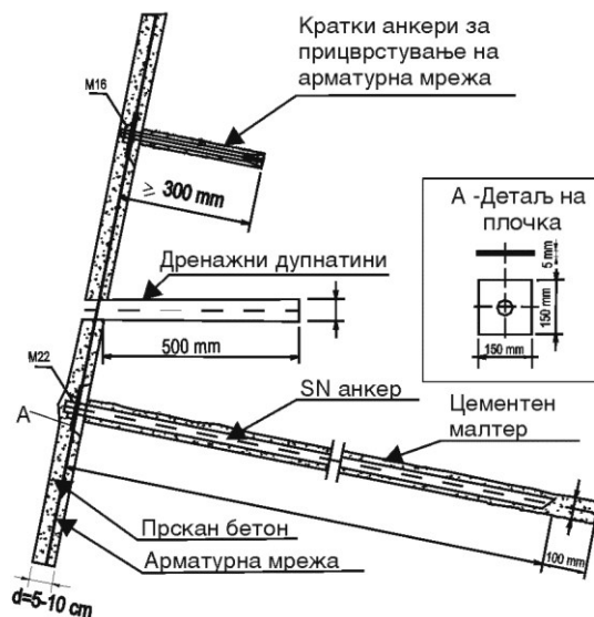
Слика 18.22 Основни елементи на еден пасивен атхезиски SN-анкер
