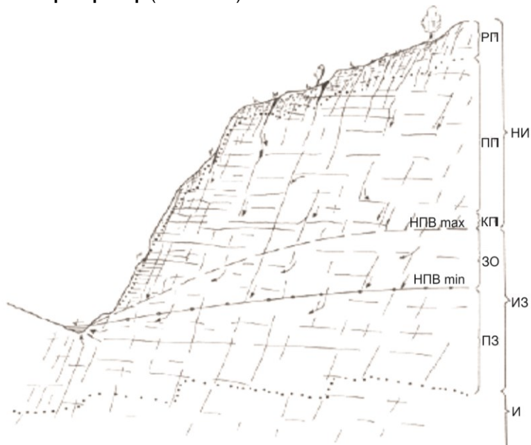
Слика 8.1 Шематски хидрогеолошки пресек на теренот: НИ) надизданска зона; РП) рудински појас; ЗО) зона на осцилации на ниво на подземна вода, ПП) преоден појас; КП) капиларен појас; ИЗ) изданска зона и издан во неа; И) изолаторски слој; ПЗ) постојана изданска зона; НПВmax и НПВmin) максимално односно минимално ниво на подземна вода во различни временски периоди (делумно модифицирано според Лапчевиќ, 2005)
