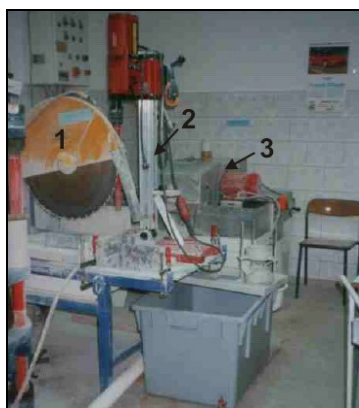
Слика 4.8 Опрема за подготовка на пробни тела за испитување: 1) машина со дијамантска пила за сечење примероци; 2) машина за дупчење примероци; 3) машина за полирање
