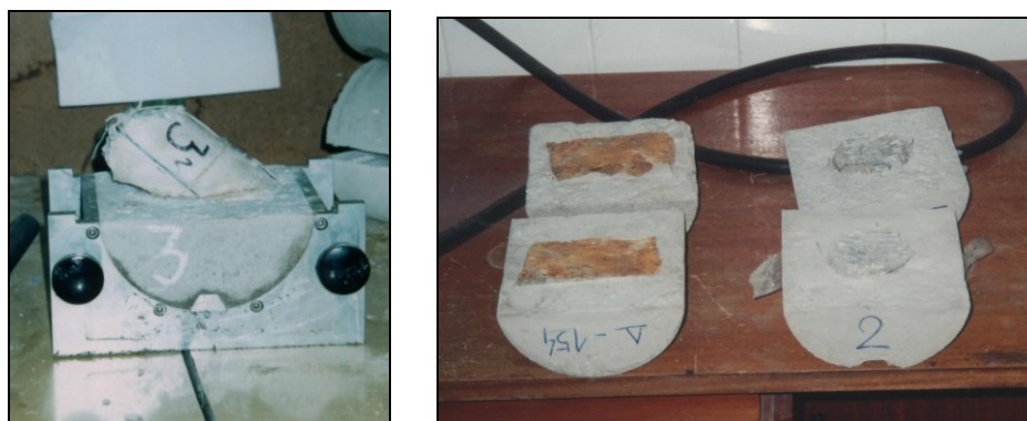
Слика 13.19 Изглед на примероци при вградување во калап во Хекова кутија (лево) и изглед на примероци од различни пукнатини по смолкнување (десно)
