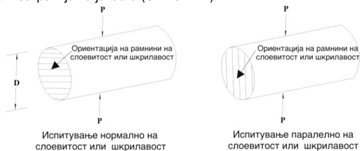
Слика 4.17 Насоки на испитување кај анизотропни карпи
