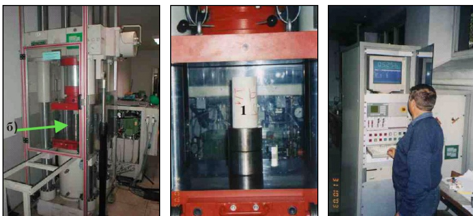
Слика 4.9 Преса за испитување јакост на притисок на карпести примероци со „сопствена контрола“ со поглед кон вкупен систем за приложување на оптоварување (лево); детаљ од пресата со пробно тело поставено за испитување со ознака 1 (средина) и компјутерска единица за автоматска манипулација (десно).
