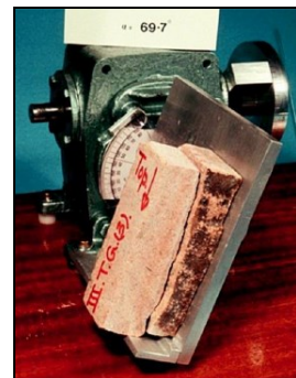
Слика 13.27 Слика за процена на коефициентот на рапавост на пукнатините (лево) и видови тест на наклон на јадро од дупнатина и парчиња од карпа со пукнатина (десно)
