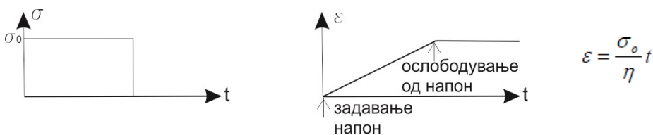
Слика 14.6 Приказ на крива на ползење за фаза на брзо прилагање на товар кога се забележува одреден наклон на кривата, кој е дефиниран со односот \sigma / \eta
