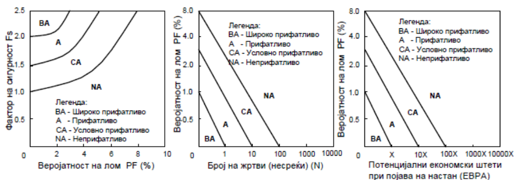
Слика 21.53 Дијаграми со области на различни нивоа на фактор на сигурност и веројатност на лом: NA – неприфатлива област; CA – условноприфатлива област; A – прифатлива област; BA – широко прифатлива област (Пешевски и др. 2018)
