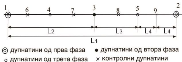
Слика 18.15 Пробно инјекциско поле во еден ред : L1,L2,L3,L4 – растојание меѓу соодветните фази, односно групи на дупнатини
