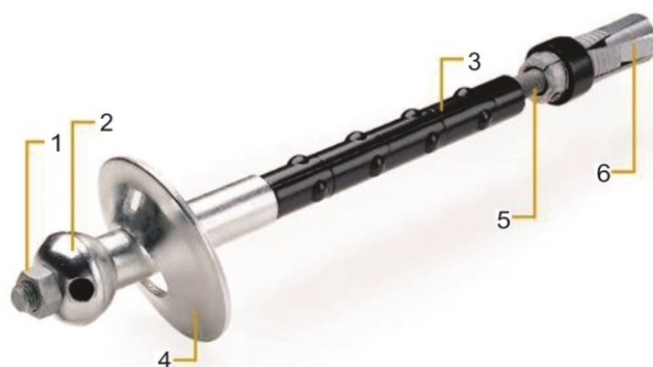
Слика 18.31 СТ-сидро од производителот DYWIDAG-Systems International: 1 - навртка, 2 - додаток за инјектирање во форма на т.н. дома со отвор за инјектирање и заварен ракав, 3 - полиетиленски ракав со ребраста форма и со внатрешни централизери, 4 - плочка со отвор за истекување на инјекциска смеса, 5 –ребрасто анкерно сидро со навои на двете страни за поставување на експанзиската капсула и навртката и 6 - експанзиска чаура
