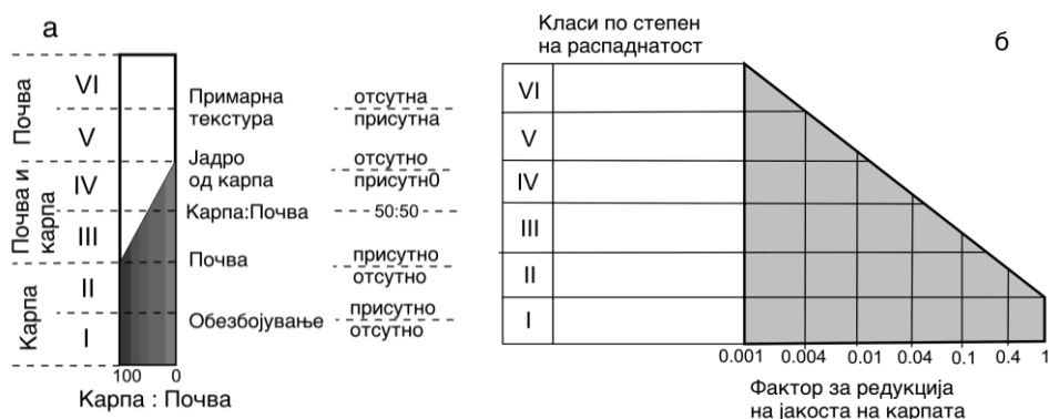
Слика 7.3 а - Шематски приказ на класите на распадатост според Дирман; б – приказ на влијание на распадатоста врз јакоста на карпата (според Стејси и Пејџ, 1986)
