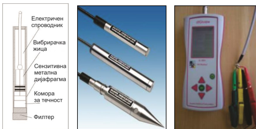
Слика 19.16 Пиезометар со вибрирачка жица (лево) и различни дигитални уреди за читање податоци од пиезометар со вибрирачка жица (на средина и десно)
