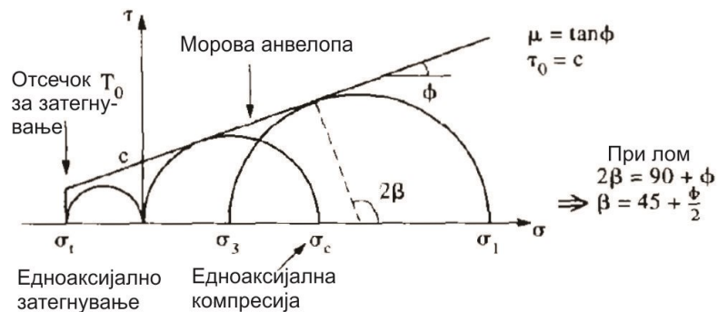
Слика 3.10. Приказ на главни нормални ( \sigma_3 и \sigma_1 ) за конструкција на зависност \tau = f(\sigma) и крива на лом во вид на анvelopa на Морови кругови на напони
