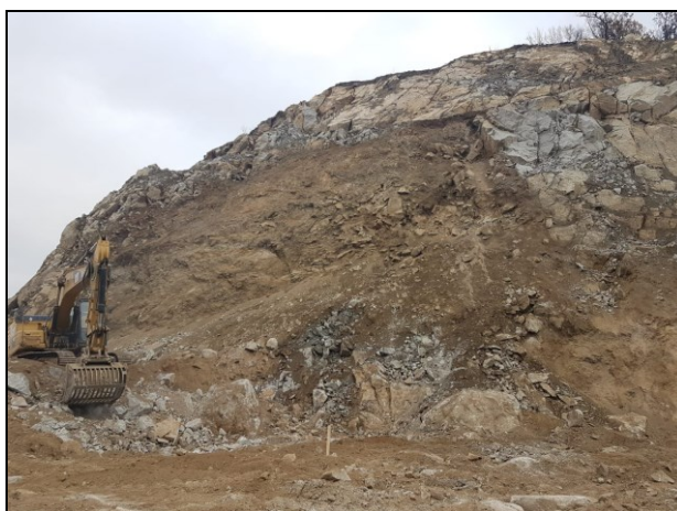
Слика 6.1 Реален изглед на еден хетероген андезитски масив по состојба на испуканост и распаднаст: квазихомогени зони на многу испукан, распаднаст и хидротермално изменет андезит (кафеава боја) и посвеж, блоковски испукан андезит (сива боја) од патот Штип - Радовиш (фотографија од Т. Јовановска)
