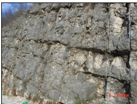
Слика 10.15 Банковити варовници во близина на локалитет Бијела на магистрален пат Сараево, трансверзално изотропен до ортотропен масив (фотографија од А. Крвавац)
