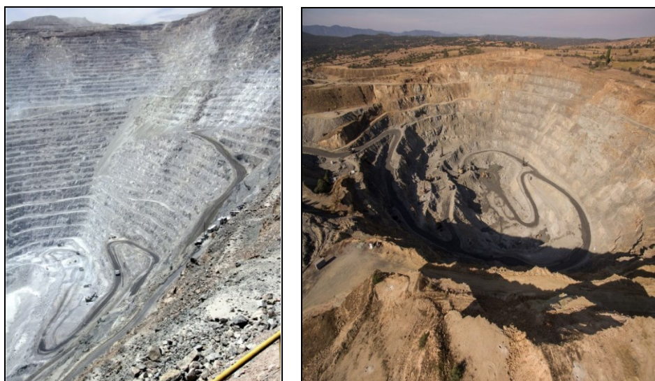
Слика 21.43 Примери за длабоки површински копови: Источна косина на површинскиот коп „Чинкуакамата“ во Чиле со: должина 4 км, ширина 3 км и длабина околу 1 км (лево) и површински коп за бакар „Бучим“ – Радовиш, со длабина до околу 250 м (десно)
