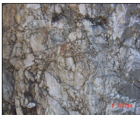
Слика 10.16 Многу испукани мермери, од патот за браната „Света Петка”, со повеќе системи на пукнатини, изотропен масив
