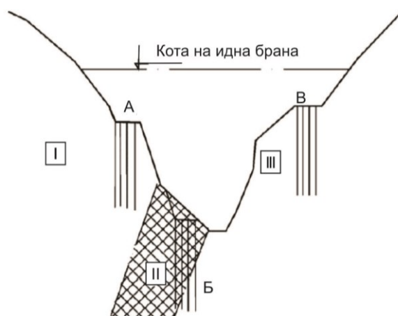
Сл. 18.13 Една шема за избор на локација и број на инјекциските полиња:
