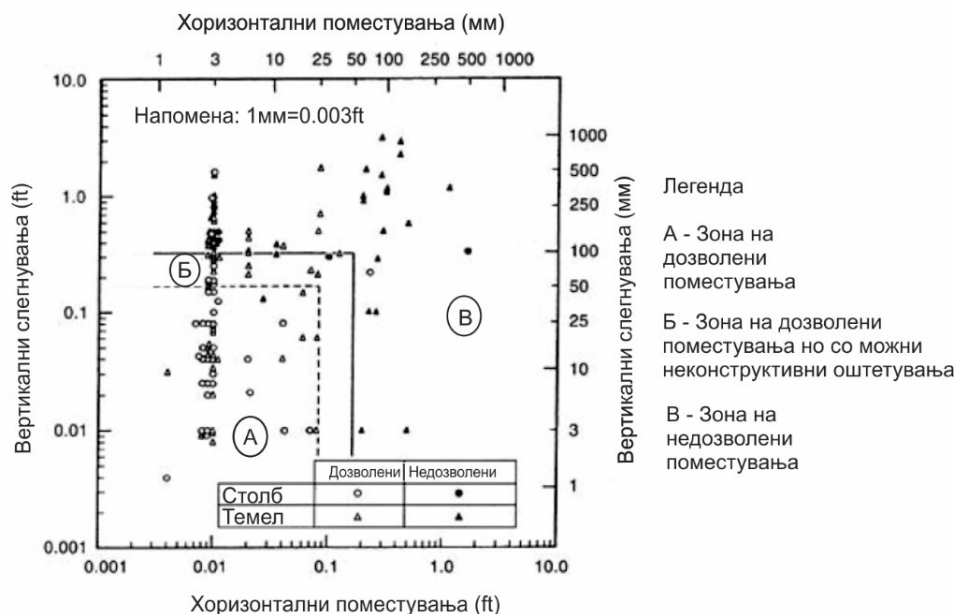
Слика 15.14 Поделба на поместувања за процена на однесувањето на столбови и темели кај мостовски конструкции (Бозозук 1978)
