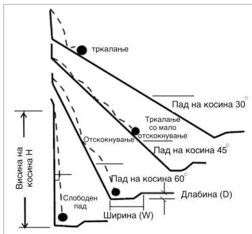
Слика 16.45 Приказ на можни начини на движење на одронети блокови, зависно од падниот агол на падината (преземено од FHWA, Прирачник „Карпести косини“, ноември 1991)
