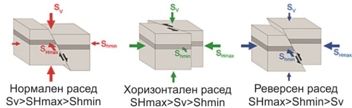
Слика 9.5 Приказ на односи меѓу главните напони кај гравитациски расед (лево), кај хоризонтални раседи (средина) и кај реверсни раседи (десно)
