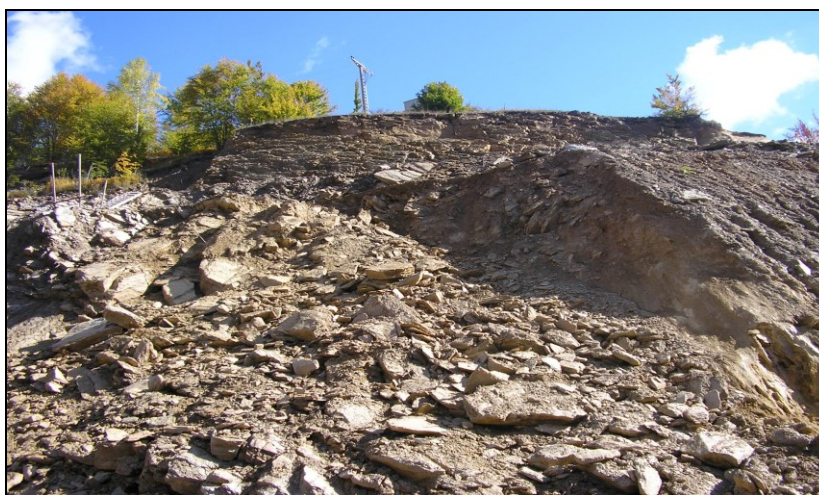
Слика 22.20 Појава на смолкнување на шкрилести карпи со неповолен пад во зона на излез од опточен тунел за браната „Кнежево“, Злетовско
