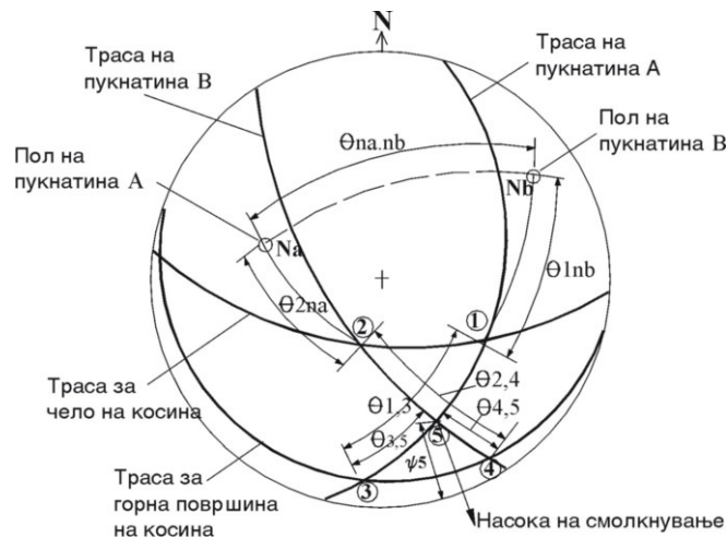
Слика 16.29 Приказ на потребни агли и параметри на стереографска проекција за пресметка на стабилност на клин, омеѓен со две пукнатини
