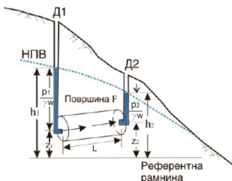
Слика 8.6 Приказ на поле на притисок во две дупнатини (Д 1 и Д 2 ), во однос на една референтна рамнина: h_1 и h_2 – големина на притисок од вода во пресек со дупнатини Д 1 и Д 2 ; z_1 и z_2 – геодетска висина во однос на референтна рамнина во двете точки; p/\gamma_w – притисок од вода или порен притисок во конкретна точка
