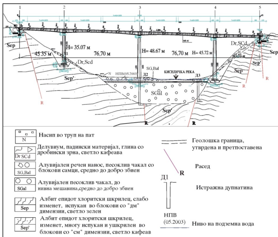
Слика 21.39 Инженерскогеолошки профил за мост преку Киселичка Река од автопатско решение за Коридорот К8 од Крива Паланка кон Деве Баир, како основа за избор на тип на фундаирање на мостот.
