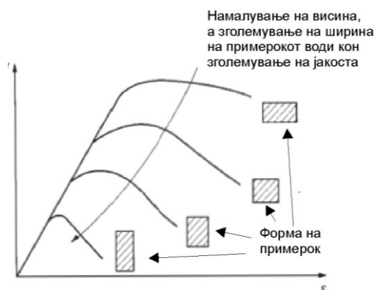
Слика 4.12. Приказ на влијание на промена на висина и ширина на примерок врз вредноста на јакоста на карпата
