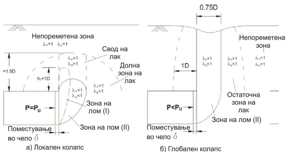
Слика 22.27 Приказ на развој на локална (лево) или глобална нестабилност (десно) во чело на ископ, со појава на т.н. „ефект на оџак“ (Џијинг 2017)
