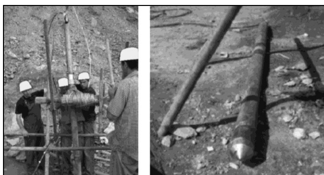
Слика 12.25 Сондажен дилатометар тип Интерфелс 96 на локација на испитување кај рудникот 'Ржаново, Кавадаречко (фотографија од М.Јовановски)
