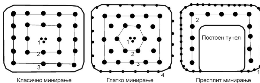
Слика 22.46 Приказ на разни техники на минирање кај подземни ископи
