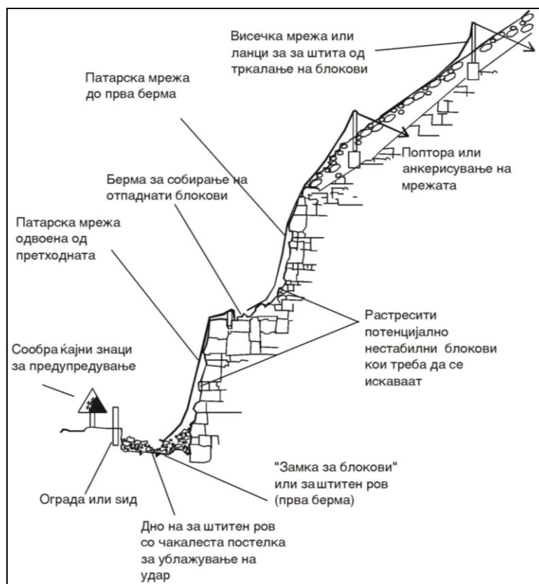
Слика 21.8 Најчести заштитни мерки за спречување на одрони, според Фукс и Свинеј (1976)
