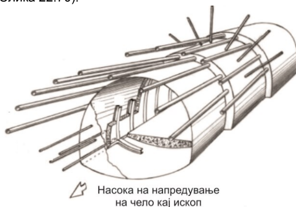
Слика 22.70 Шематски приказ на методот на заштитен чадор кај меки карпести маси
