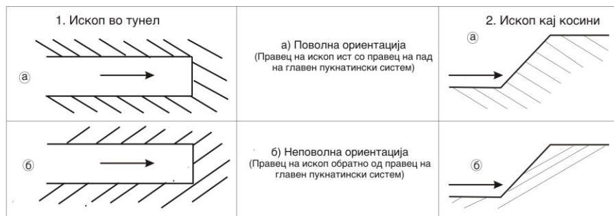
Слика 11.2 Приказ на поволна и неповолна ориентација на напредување на ископот, во однос на падниот агол на пукнатински систем
