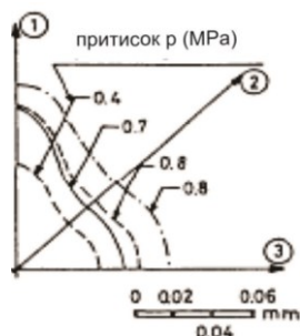
Слика 12.10 Споредба на добиени модули на деформација во два правци, како пример за изразена анизотропија
