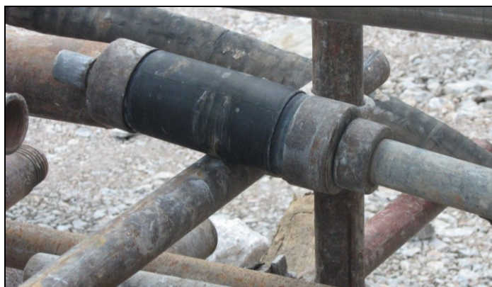
Слика 8.14 Изглед на гумен дел, наречен пакер, поставен на дупчечките шипки, за изолирање на делницата за испитување
