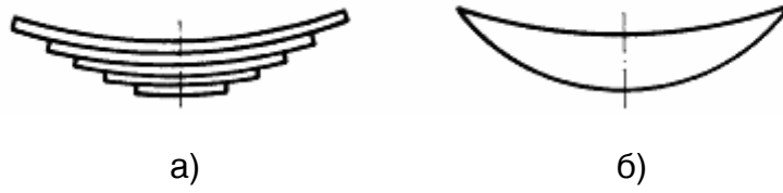
Сл.269. Упростено а) и шематско б) претставување на флексиони (лисни) пружини
