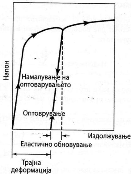
Сл.103. Дијаграм на оптоварување и растоварување на епруветата изработена од материјал кој се испитува на затегнување.
