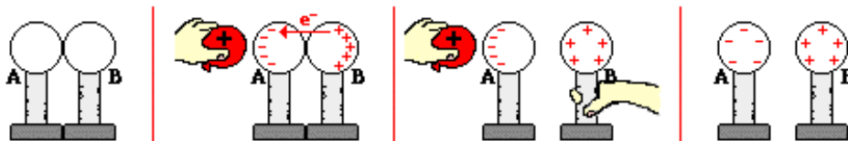
Сл.2.9. Електризирање кај двосферен систем со користење на позитивно наелектризиран објект
