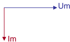
Сл.9.12. Фазорски дијаграм на електрично коло со омска и индуктивна отпорност
