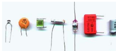
Сл.2.32. Различни видови кондензатори: повеќеслоен керамички, диск керамички, повеќеслоен фолијски, цвечест керамички, полистиролски (оксијален и радијален), електролитски.
