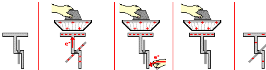
Сл.2.6. Електризирање со кондукција
