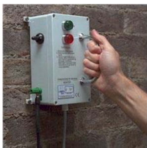
Сл.2.14. Електростатички мерен инструмент за мерење на електростатичко празнење
