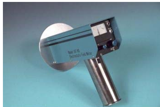
Сл.2.13. Електростатички мерни инструменти за мерење на јачината на електричното поле и на поларитетот
