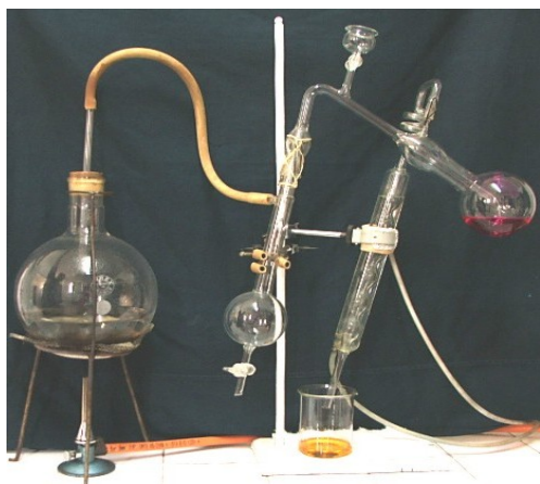
Слика 48. – Келдалова апаратура за дигестија на протеини: а) Со брeнер б) Електрична
