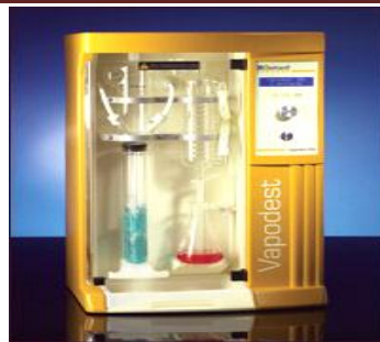
Слика 47– Автоматски Келдал (Kjeldahl) апарат за: а) Дигестија и б) Титрација
