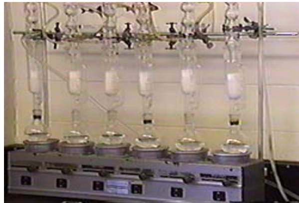
Слика 50. – Поставен Соклестов (Soxhlet) апарат на водена бања (или специјални грејни лежишта).
