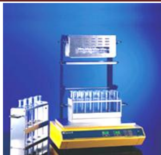
Слика 47– Автоматски Келдал (Kjeldahl) апарат за: а) Дигестија и б) Титрација
