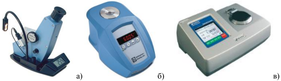
Слика 32. – Статични рефрактометри: а) Абеов (Abbe) рефрактометар, б) Дигитален рефрактометар, в) Автоматски дигитален рефрактометар
