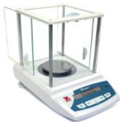
Слика 27. – Потребна апаратура: а) Аналитичка вага, б) Сушилница
