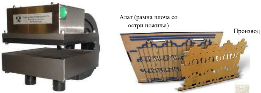
Слика 6.1 Машина и алат за просекување и втиснување со рамни плочи
