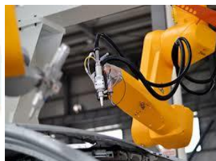
Слика 6.5 Ласерска машина за сечење со повеќе оски (за тридимензионални форми)
