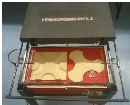
Слика 5.25 а) Изработка на машина за термообликување со вакуум изработена од студентите на Машински факултет во Скопје
