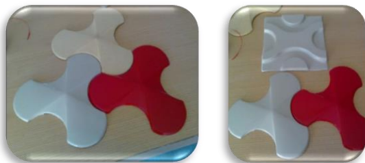
Слика 5.25 а) Изработка на машина за термообликување со вакуум изработена од студентите на Машински факултет во Скопје
