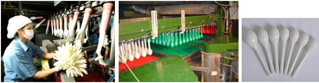
Слика 6.8 Приказ на процесот и алатот за обликување со потопување
