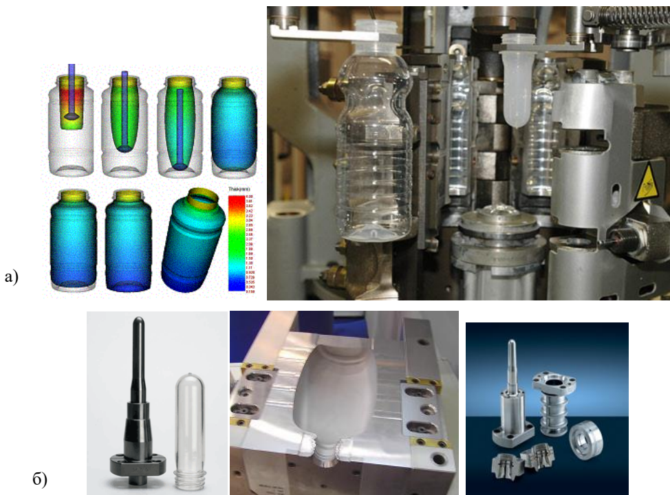
Слика 5.32 Елементи од процесот инјекционо развлекување - дување: а) приказ на процесот и б) елементи од алатот
