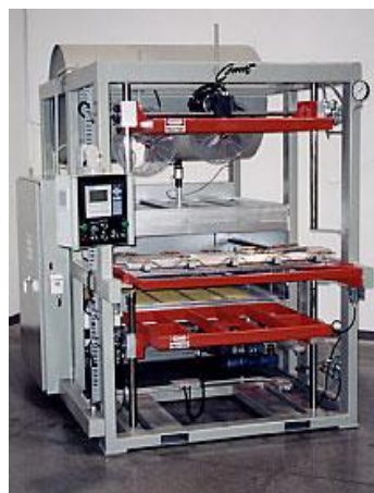
Слика 5.24 Шематски приказ на машината за термообликување со притисок
