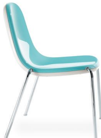
Слика 3.30 butterfly chair Дизајн на Karim Rashid, 2003, Производител: Magis Предниот и задниот дел се изработени од ABS инјекционо пресуван, а рамката е од хромиран челик. Се одликува со мека елегантна линија и блескави бои. Едноставно се ставаат една врз друга. http://hivemodern.com/pages/products.php?sid=605
