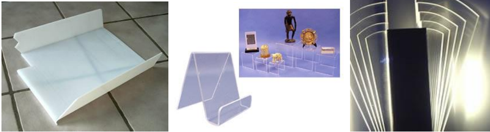
Слика 5.26 Производи добиени со процесот на свиткување со загревање
