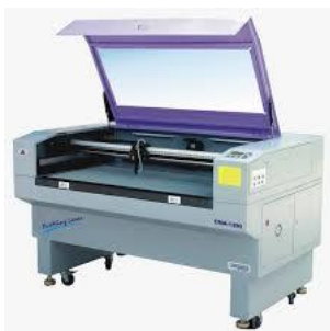
Слика 6.4 Ласерска машина за сечење со две оски (за рамни материјали)
