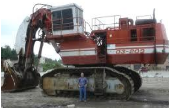
Сл. 5.29. Tri-Power концепција на ХБЧК (O&K RH 120C)
