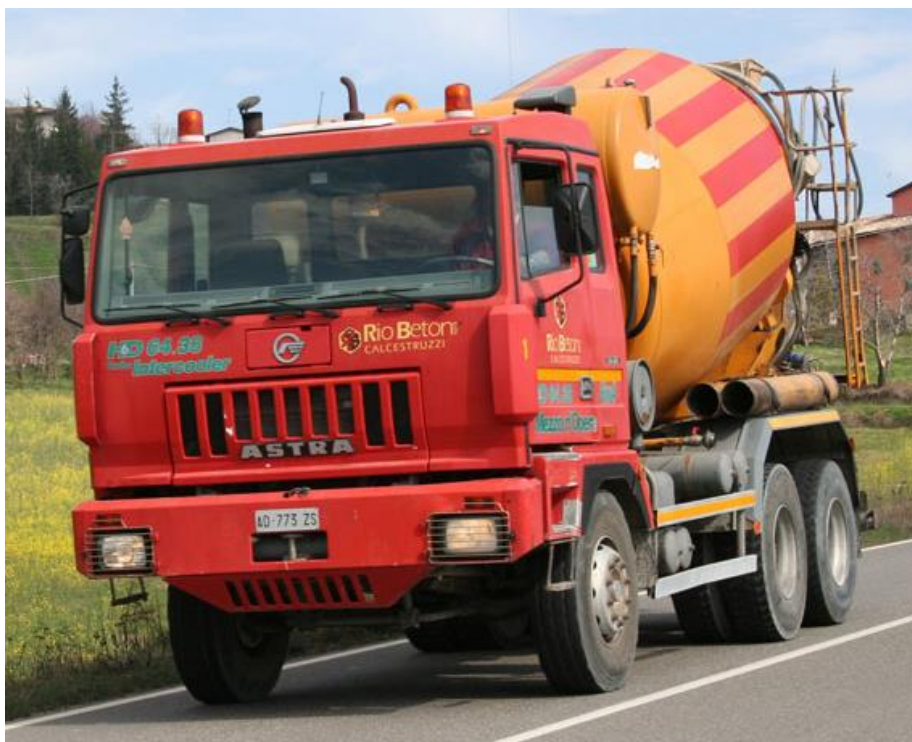
Сл. 18.6. Изглед на една мобилна самоодна гравитациска мешалка (т.н. камион миксер)
