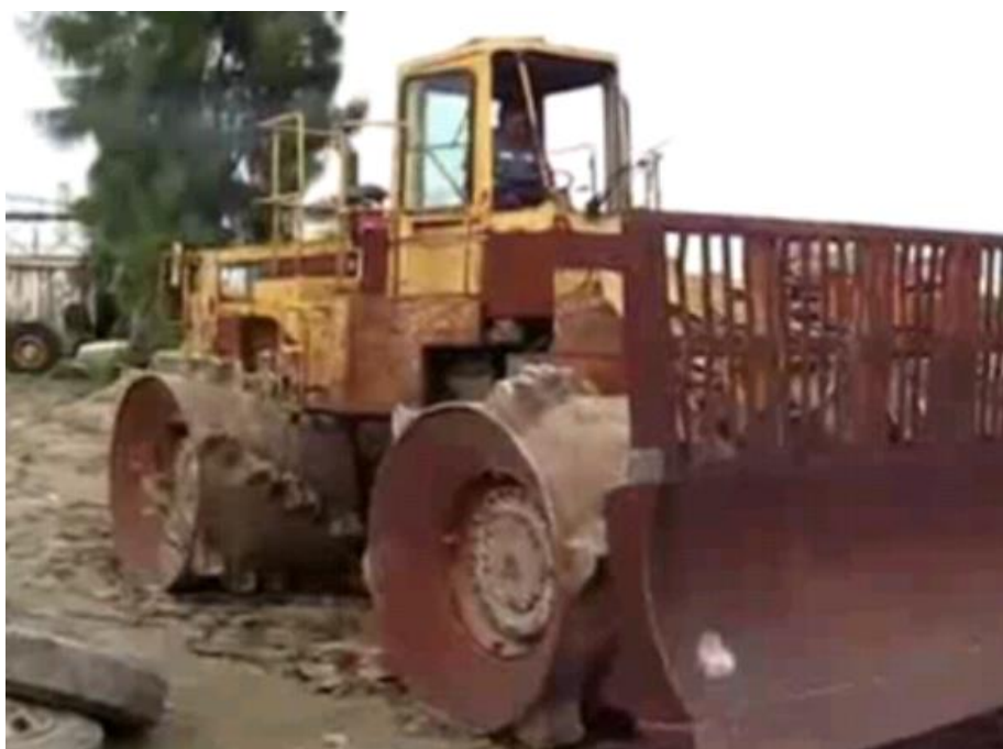
Сл. 8.7. Дозер со крути тркала за работа во отпад или во каменолом каде што подлогата е со остри предмети
