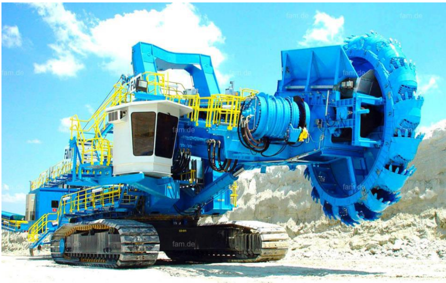
Сл. 5.50. Мал самооден рударски багер (компакт роторен багер)
