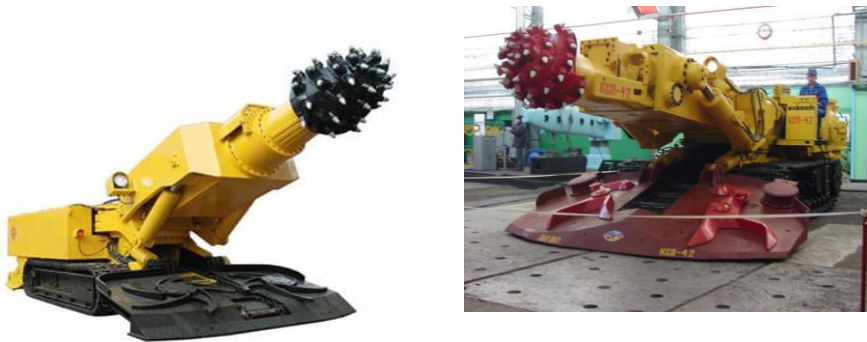
Сл. 21.1. Изглед на јамски комбајни со еден барабански ротор
