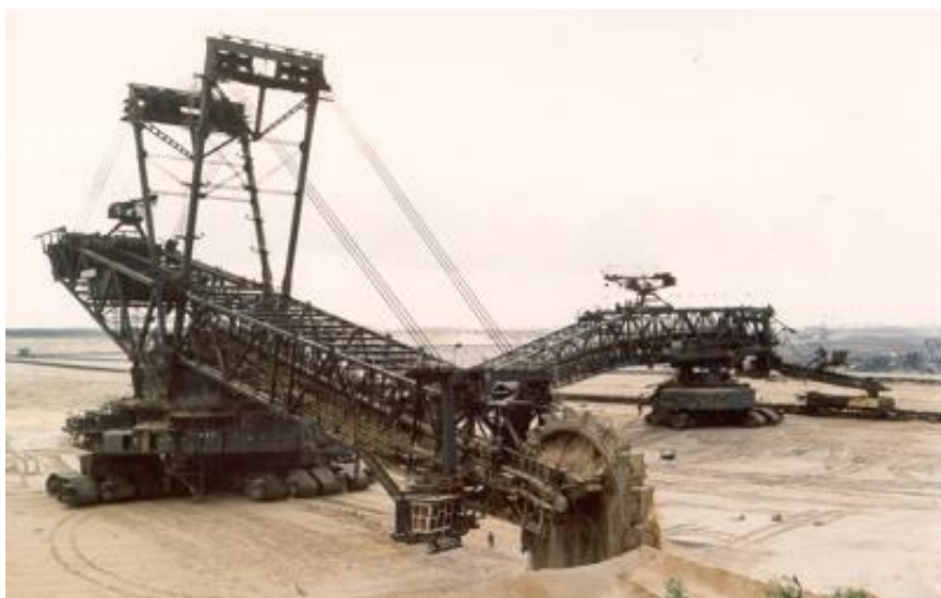
Сл. 5.52. Самооден роторен багер на површински коп
