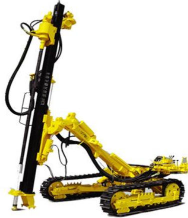
Сл. 6.6. Дупчалка поставена на лафет (постар модел) и модерна дупчалка
