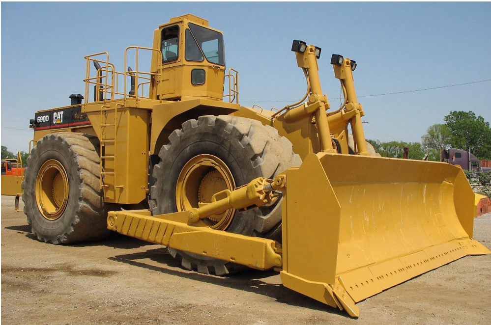
Сл. 8.4. Дозер со хидраулично подигање на ралникот. Поставен е на пневматици
