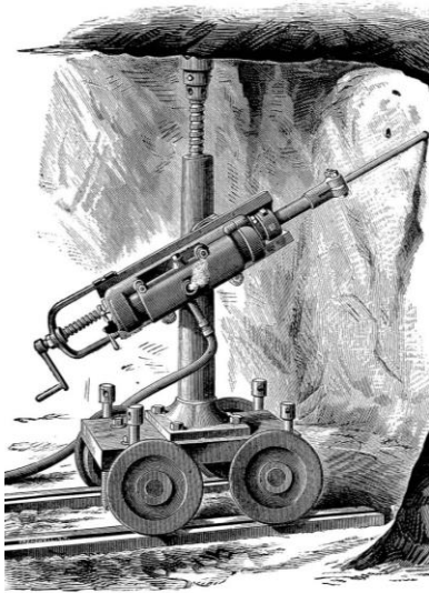
Сл. 6.6. Дупчалка поставена на лафет (постар модел) и модерна дупчалка
