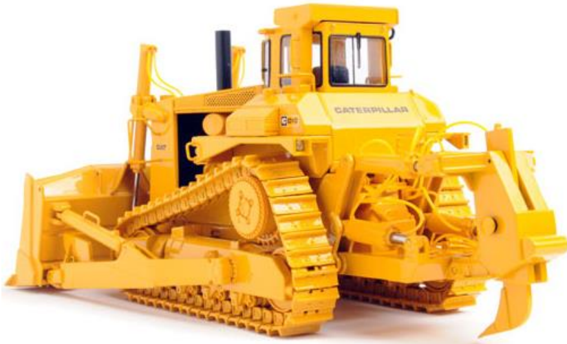
Сл. 8.8. Дозер гасеничар, со кабина – со хидраулично подигање на ножот и риперот
