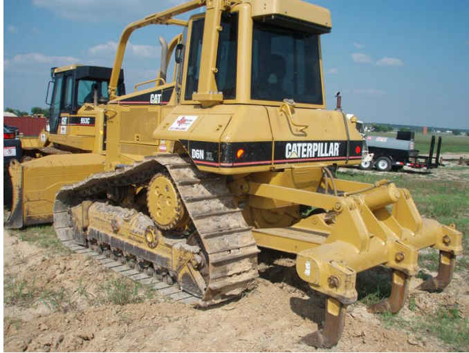
Сл. 8.10. Дозер со ријач (рипер) со три распорувачи
