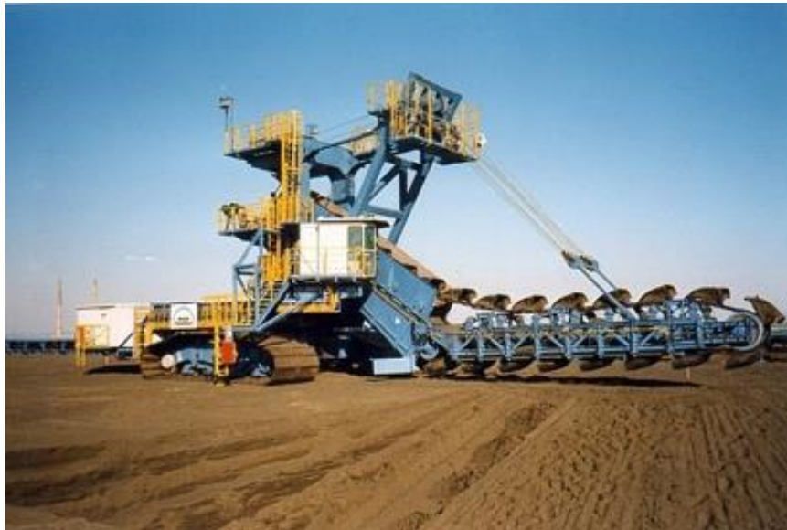
Сл. 5.41. Попречен верижен багер применет во рударството
