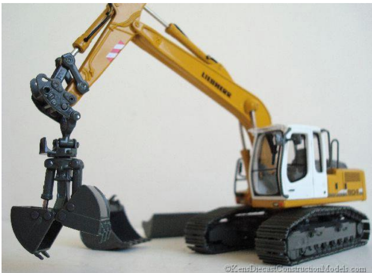
Сл. 5.36. Хидрауличен багер со монтиран грајфер на ХБОЛ
