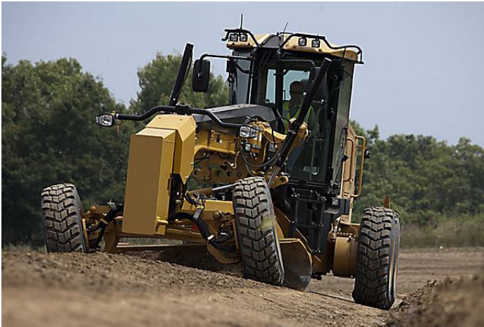
Сл. 10.9. Маневрирање со тркалата на самооден грејдер на наклонет терен
