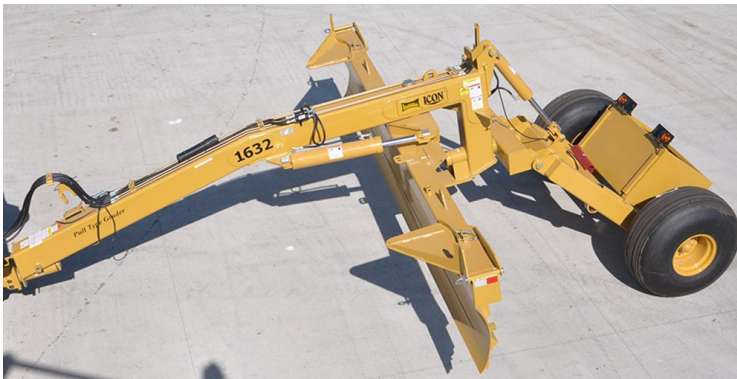
Сл. 10.1. Едноосен влечен грејдер со хидраулично управување со ралникот
