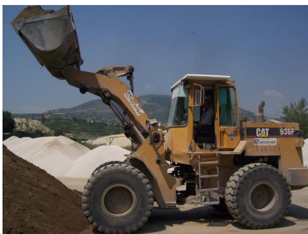
Сл. 7.3. Челен товарач – (а) црпење, (б) подигање, (в) исипување
