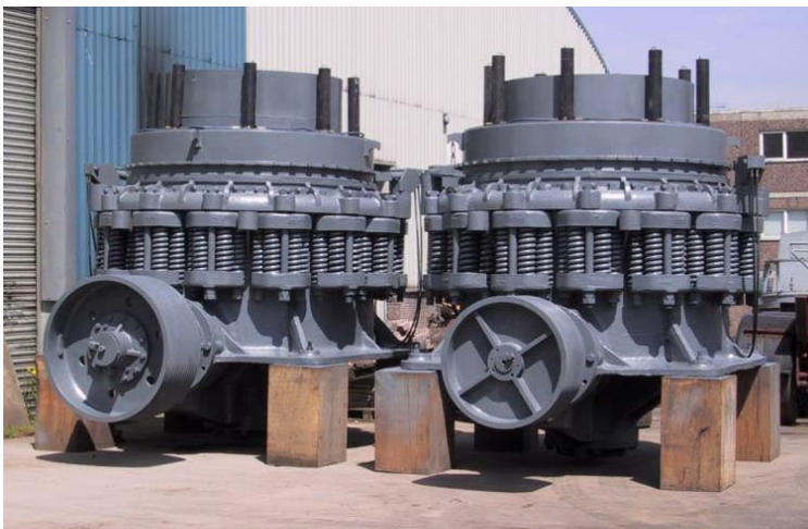
Сл. 13.9. Изглед на конзолни конусни дробилки со константна зона
