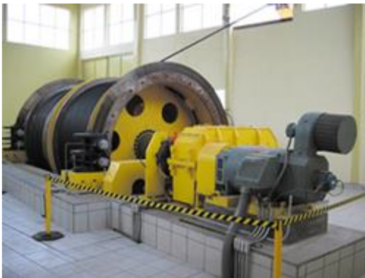
Сл. 20.11. Извозна постројка со цилиндрични барабани
