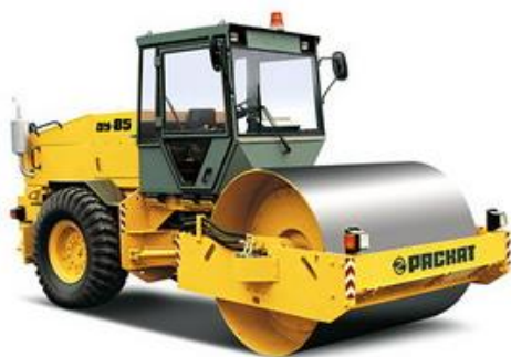
Сл. 11.10. а) Комбиниран самооден валјак со крути валјаци и пневматици, б) мал валјак за тесни површини
