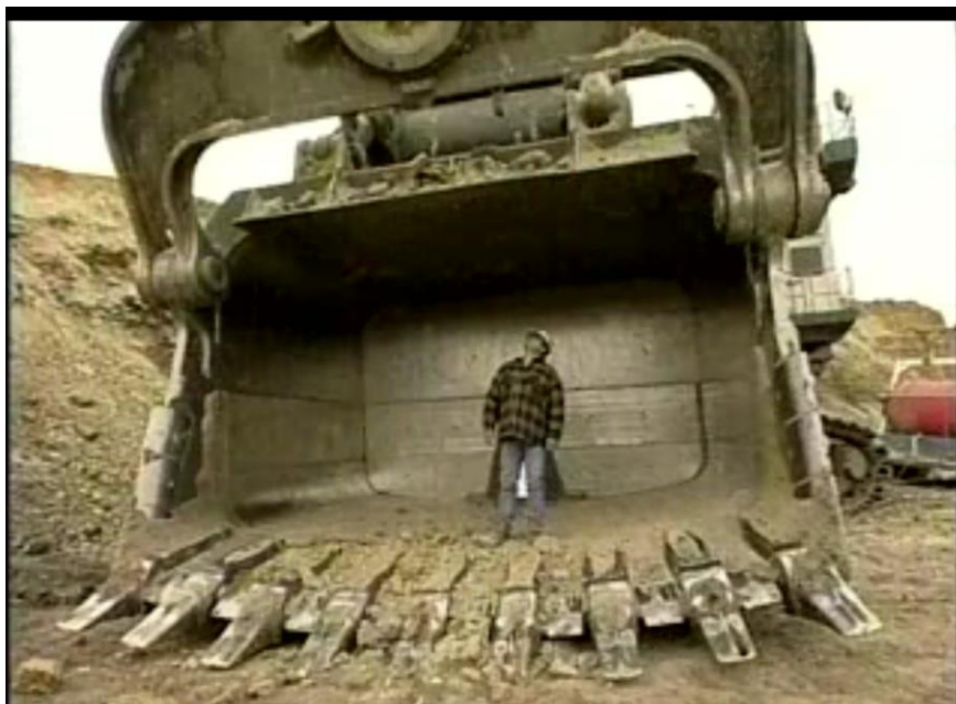
Сл. 5.4. МБЧК со голема корпа за рудници со површинска експлоатација
