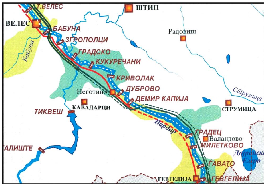
Локалитети за можни хидроцентрали на реката Вардар По текот на Вардар од Таорската Клисура до границата со Грција во должина од 200 km постојат услови за изградба на 12 хидроелектрани.
