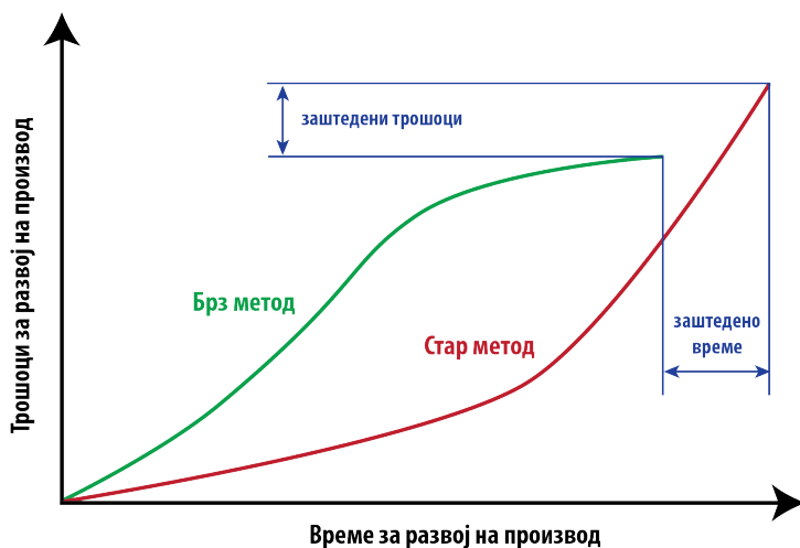
Слика 4.8. Заштеда на време и трошоци со извршување анализи на брзо изработени прототипови
