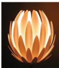
Слика 5.21 Столна лампа добиена со ласерско синтерување 16
