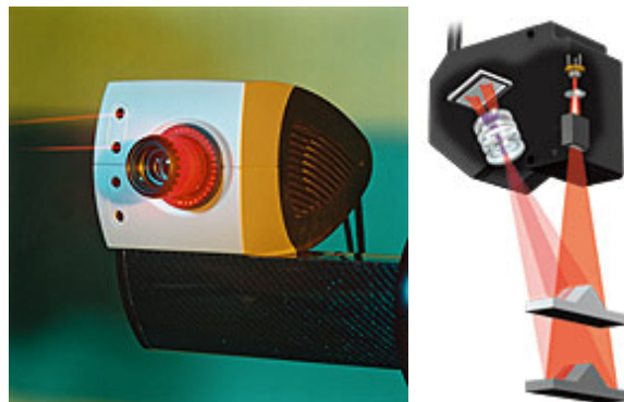
Слика 2.7. Прибирање на податоци со методот на триангулација
