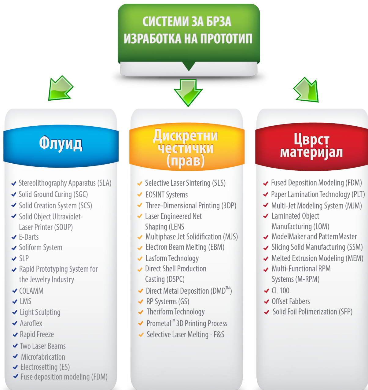
Слика 4.1. Класификација на системите за изработка на прототипови според видот на почетниот материјал
