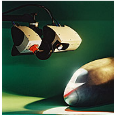
Слика 2.6. Прибирање на податоци со методот на триангулација
