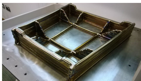
Слика 5.3 Прототипови добиени со постапка слој по слој, Layer based technology
