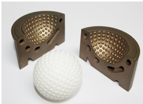
Слика 5.6: Челичен калап за изработка на топчиња за голф добиен со ласерско синтерување на метал
